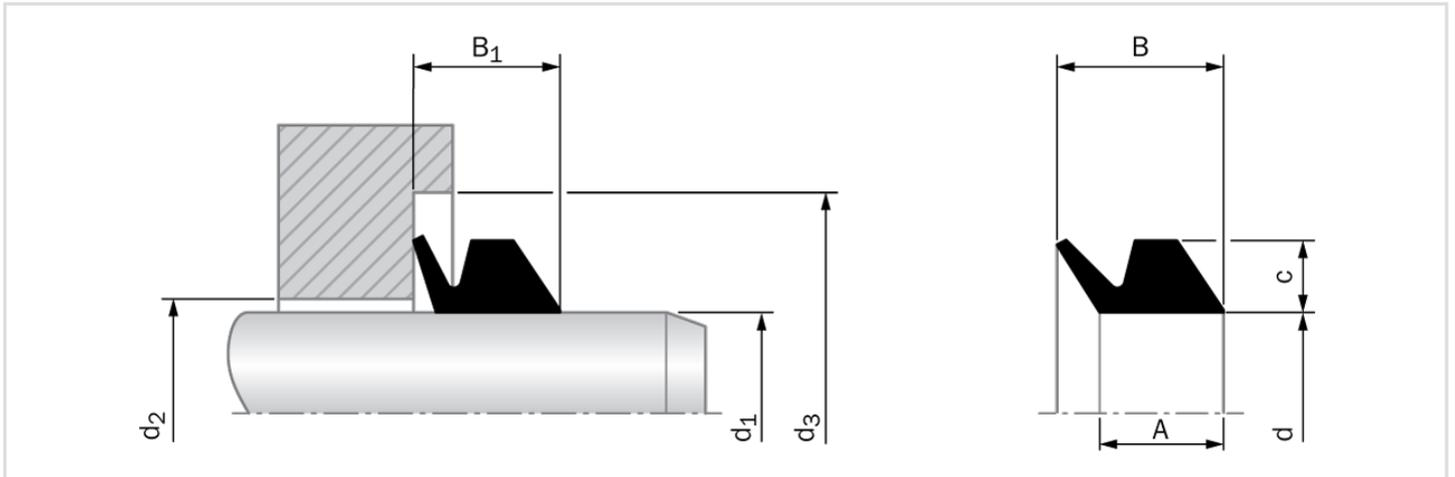
Bei Drücken ab 40 MPa bis zum angegebenen Maximaldruck bitte die Durchmessertoleranz H8/f8 (Bohrung/Stange) im Bereich der Dichtung anwenden.
